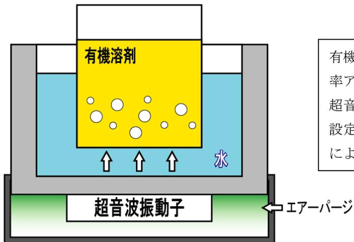
有機溶剤を間接的に超音波照射することで洗浄効率アップ、反応促進を目的とした装置です。
